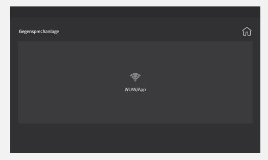
Im darauffolgenden Menü drücken Sie 2x den Button "gültig" um den Pairing-Modus zu aktivieren. Die Anlage startet nun neu und stellt für ca. 3 Minuten einen Hotspot zur Verfügung.
