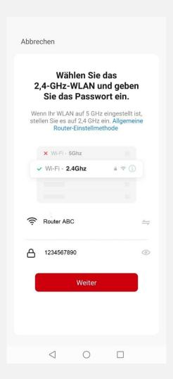
Hinweis: Sollte Ihr Router 2,4 GHz und 5 GHz unterstützen, so deaktivieren Sie bitte während der Einrichtung den 5 GHz-Kanal.
